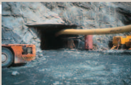
Indgangen til tunnelen i Kvanefjeldet. Ved fornyede undersøgelser på Kvanefjeldet i 1978 blev der sprængt en 960 m lang tunnel, hvorfra 20.000 ton malm blev hentet. Det kraftige udsugningsanlæg, som sikrer at radonmængden ledes væk fra minen, foregår via det store gule rør.
