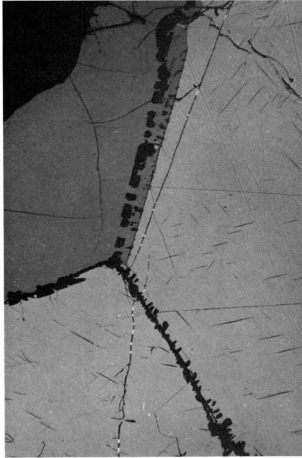
Fig. 5. Storgangen Profil I (16,5 m), Auflicht mit Ölimmersion. In einem zusammenhängenden Erzbereich mit Pflastergefüge stoßen zwei Magnetitkörner (hellgrau mit orientierter Spinellentmischung (schwarz)) und ein Korn Ilmenit (dunkler grau) zusammen. An den Korngrenzen Ilmenit gegen Magnetit und ebenfalls Magnetit gegen Magnetit kam es zur Ausscheidung von kräftigen Spinellsäumen. Dort wo ein Reaktionssaum zwischen Ilmenit und Magnetit ausgebildet ist, entspricht die kräftige Spinellreihe innerhalb des Ilmenitbereiches einer ehemaligen Korngrenze. Lange Bildseite 0,6 mm.
