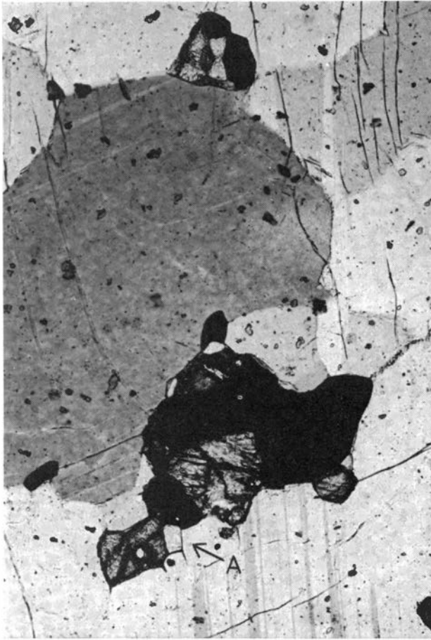
Fig. 14. Storgangen Profil I (26,4 m), Durchlicht, Nicols schräggestellt. Ein Plagioklasbereich mit Pflastergefüge, der auf Korngrenzen und in Zwickeln der Plagioklaskristalle Aggregate aus kleinen Fremdmineralkörnern enthält. Es lassen sich unterscheiden: Erz (schwarz), Pyroxen (grau mit hohem Chagrin) und Apatit (kleine helle Körner, z.B. A →). Lange Bildseite 1,4 mm.
