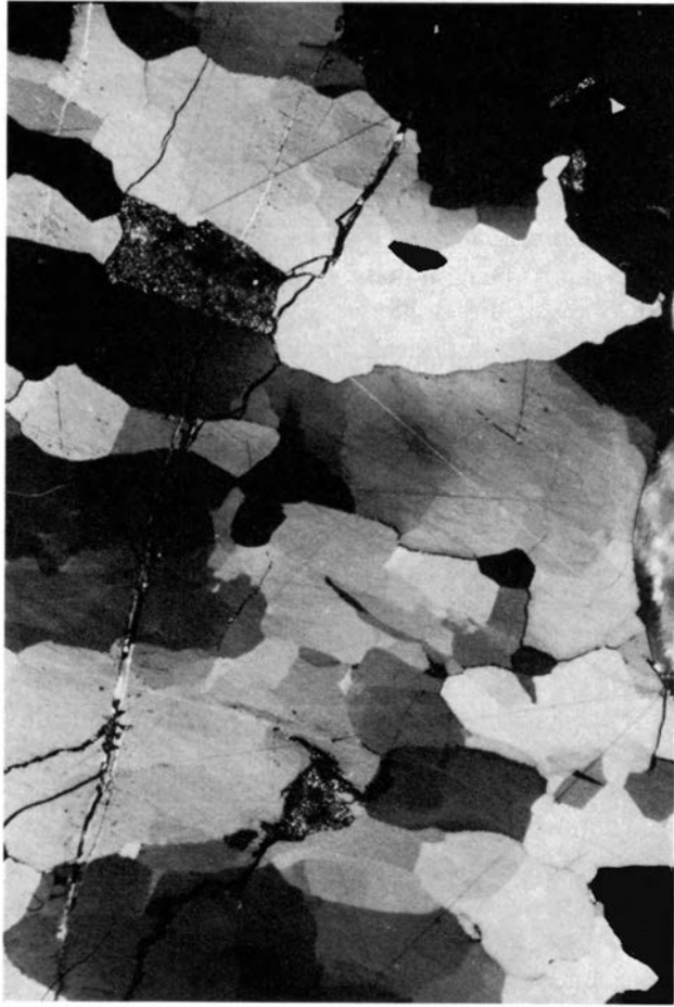
Fig. 10. Storgangen Profil I (12,8 m), Auflicht mit Ölimmersion, gekreuzte Nicols. Ein größerer Ausschnitt mit dem Magnetitkorn von Fig. 13 in der Mitte (schwarz) ist bei gekreuzten Nicols dargestellt. Ein streifiges Knitterungsgefüge wird sichtbar. Lange Bildseite 0,6 mm.
