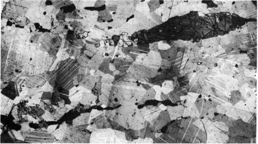
Fig. 17. Storgangen Profil I (26 m), Durchlicht, Nicols schräggestellt. Gefügebild eines Leuconorits mit Foliation. Die Plagioklasbereiche (hell) sind mosaikartig aus feinkörnigen Kristallen zusammengesetzt. Durch die streifige Anordnung der dunklen Minerale ist die Foliation erkennbar. In einem solchen Streifen liegt ein größerer, verbogener Orthopyroxenkristall, dessen Enden ausgeschwänzt sind. Der Einzelkristall löst sich auf der einen Seite in ein Aggregat aus granulierten Körnern und schließlich eine Kette von isolierten Einzelkörnern auf. Lange Bildseite 8 mm.
