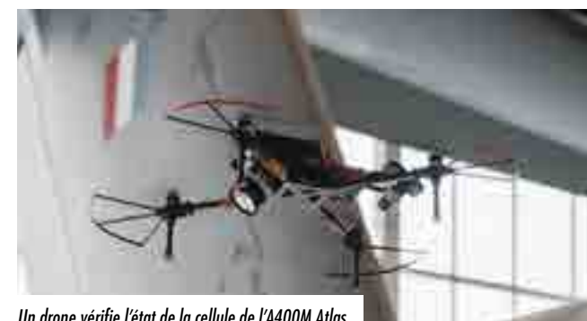
Un drone vérifie l'état de la cellule de l'A400M Atlas.
