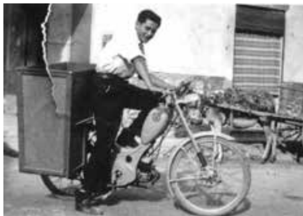
Ciclomotor en cuya parte trasera lleva acoplado un dispositivo para el transporte de mercancías.
