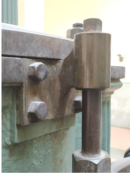
Figura 175: Conexión cilindro barra distribución
