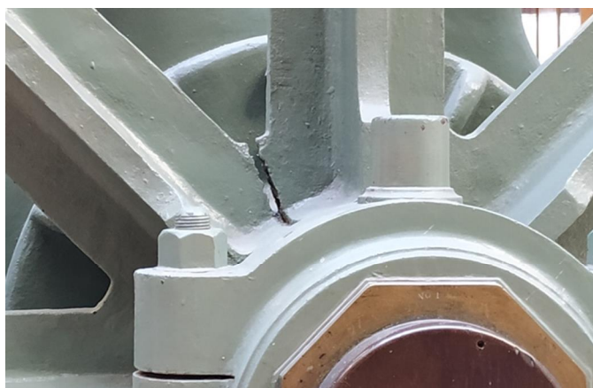
Figura 49: Fractura observable en la rueda dentada
