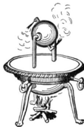
Figura 6: Eolipila de Herón de Alejandría [6]
