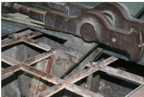
Figura 66: Conexión de excéntricas con el eje descubierto
