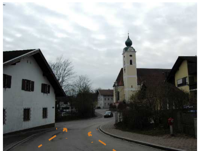
Verengung der Straße durch Gebäudestellung
