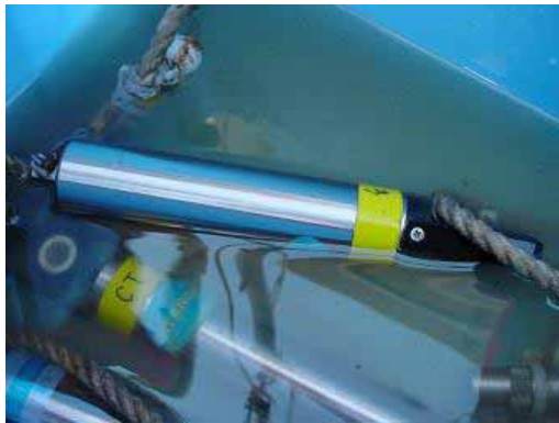
図 1.2.26 水質計測用機器写真（左：水温塩分計、右：照度計）
