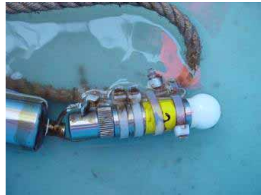
図 1.2.26 水質計測用機器写真（左：水温塩分計、右：照度計）
