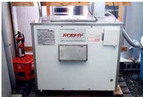
図1.2.7 高速発酵処理機(バイオメイト)
