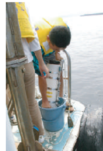
バンドーン採水器を使っでの海水の採取
