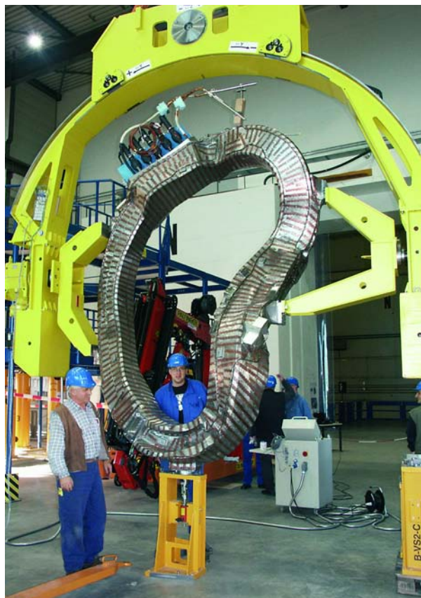
Abb. 17: Die erste nicht-ebene Magnetspule wurde 2003 nach Greifswald geliefert. Eingehängt in ein bewegliches Gestell (gelb) wird sie über das Plasmagefäß gefädelt. (Foto: IPP)
