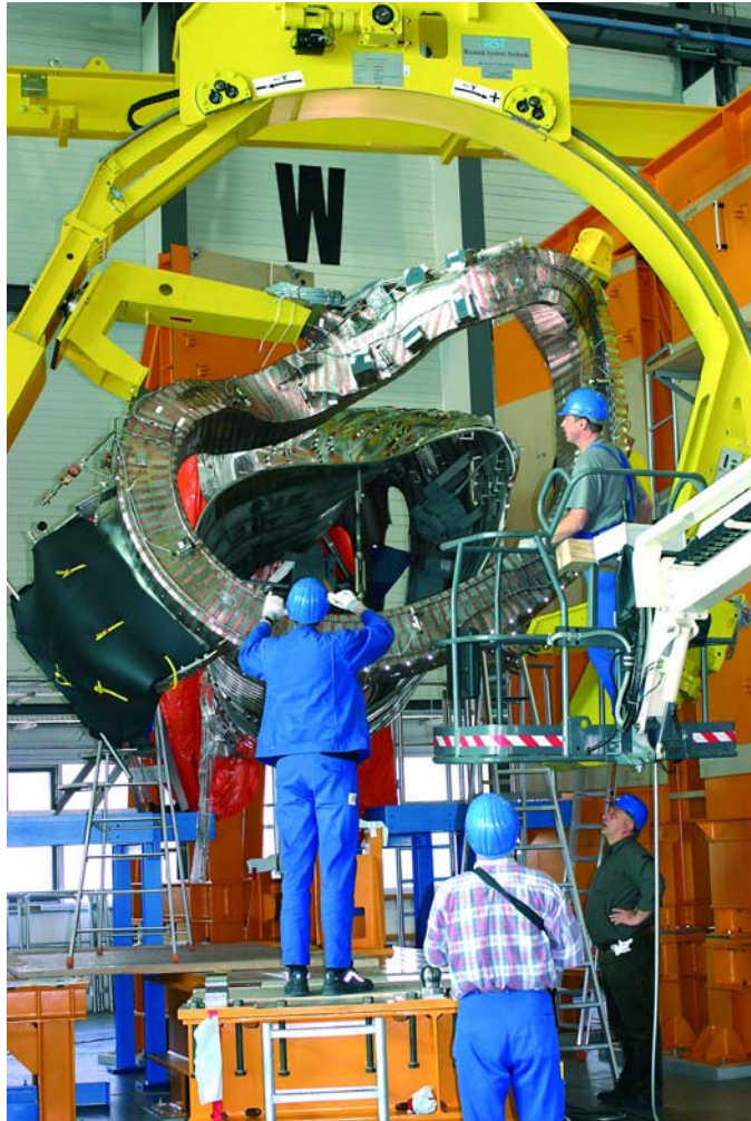
Abb. 22: Montagebeginn: Eingehängt in ein drehbares Gestell wird die erste von 50 Stellarator-Magnetspulen auf ein Segment des Plasmagefäßes gefädelt. (Foto: IPP)
