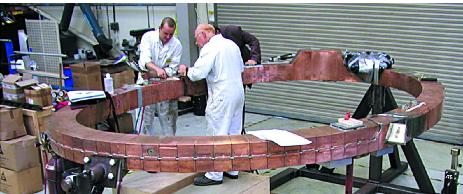
Abb. 15: Eine der 20 ebenen Magnet- spulen während der Fertigung. (Foto: IPP)
