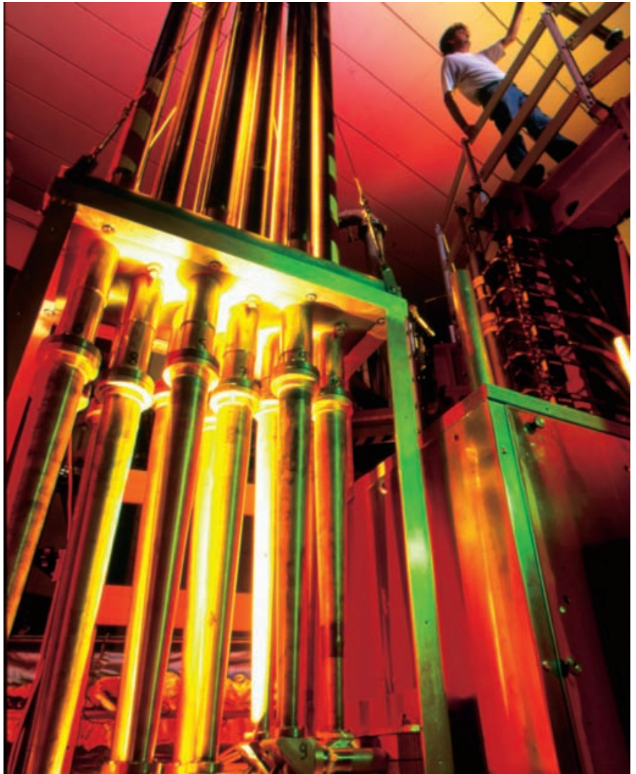
Abb. 7: Messgerät zur Bestimmung der Elektronentemperatur am Fusionsexperiment ASDEX Upgrade. Die Hohlleiter lenken die Zyklotronstrahlung der Elektronen zu Detektoren. (Foto: IPP)
