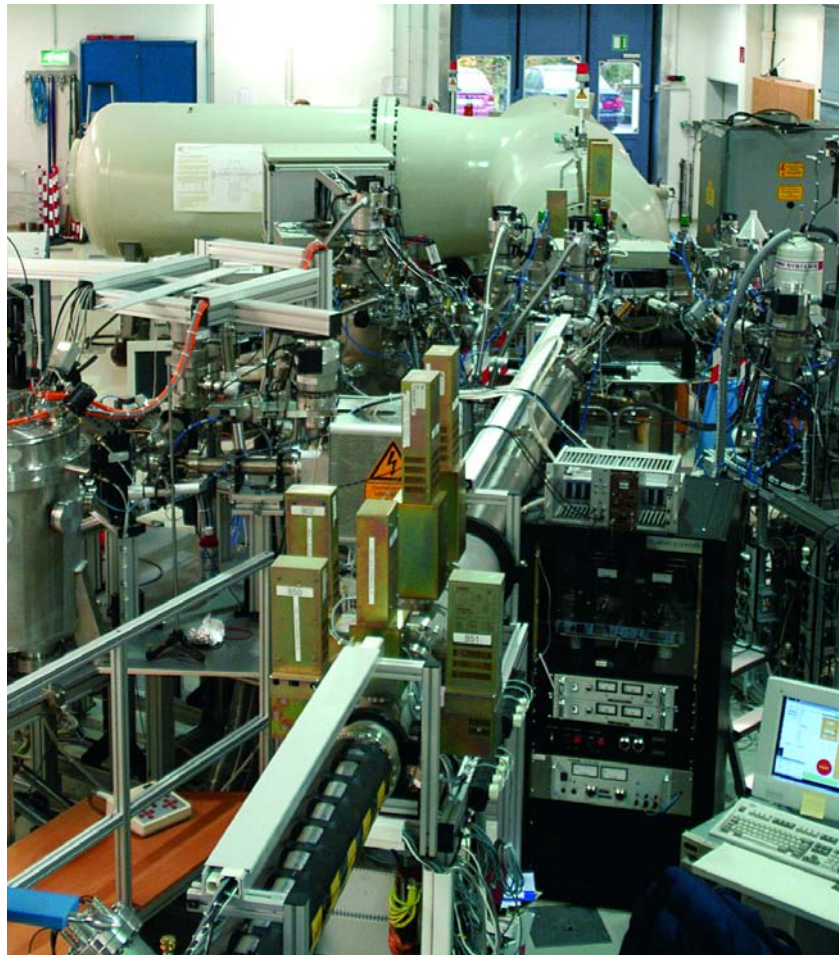
Abb. 23: Der Tandem-Beschleuniger, ein wichtiges Instrument zur Analyse der Wechselwirkungen zwischen Plasma und Gefäßwand. (Foto: IPP)
