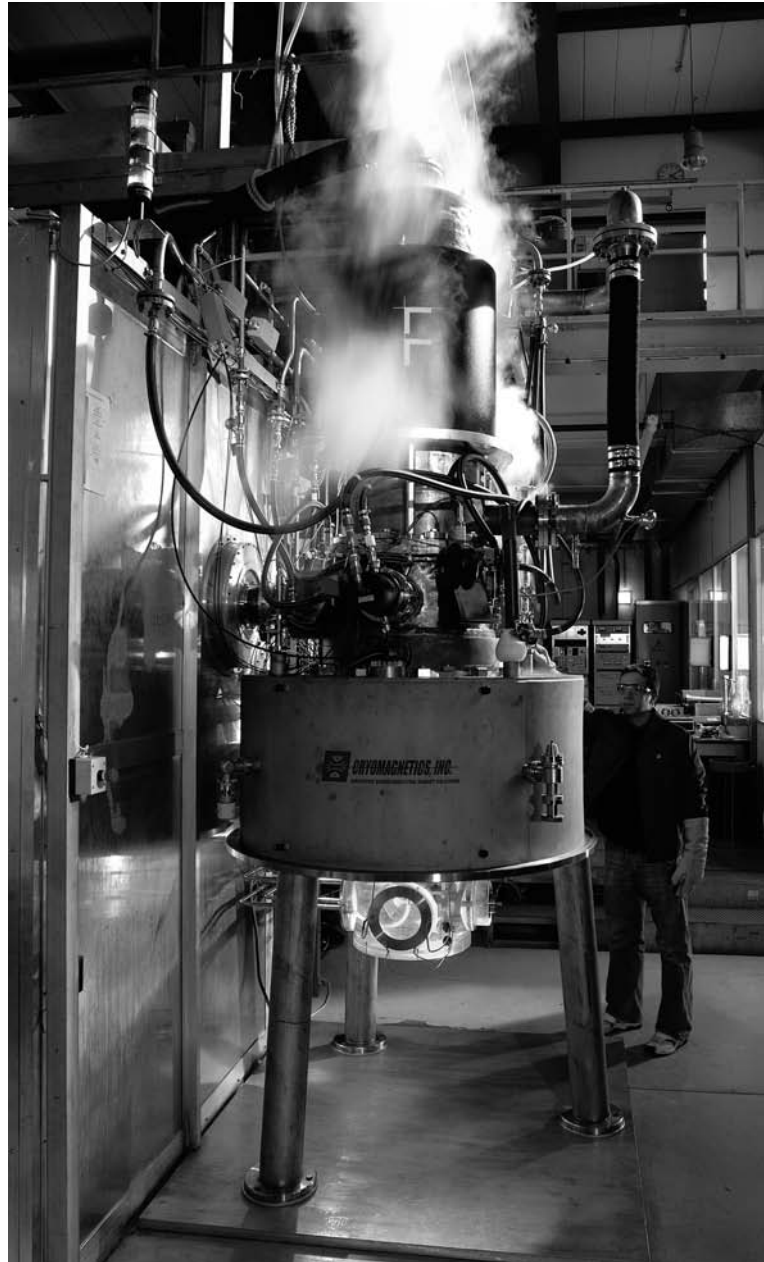
Abb. 1: Wendelstein 7-X Gyrotron im Hochleistungstest- stand. Die Wolke ent- steht durch verdamp- fenden flüssigen Stickstoff beim Auffüllen des Kryostaten für den supraleitenden Magneten. (Foto: FZK)
