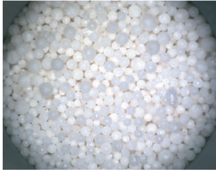
Abb. 7: Lithium-Orthosilikatkügelchen mit einem Durchmesser von 0,25 bis 0,63 Millimeter aus dem Schmelz- Sprüh-Prozess der Fa. Schott AG. (Foto: FZK)
