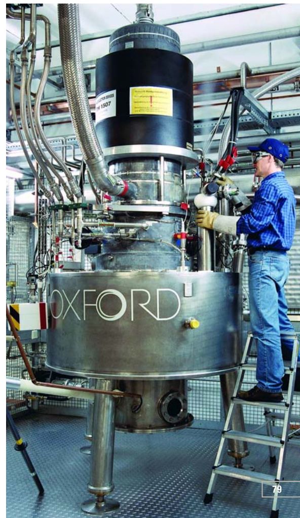
Abb. 20: Die erste vom Forschungszentrum Karlsruhe an das IPP ausgelieferte Mikrowellenröhre. (Foto: IPP)
