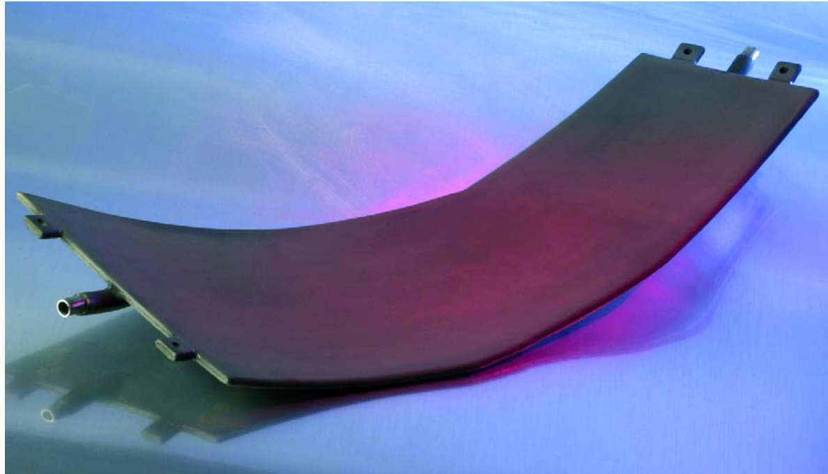
Abb. 25: Wandverkleidung für Wendelstein 7-X mit Borkarbid-Beschichtung (Prototyp) (Foto: IPP)
