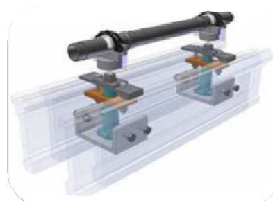
Figura No. 2- 118. Soportes rectificador Tubos
