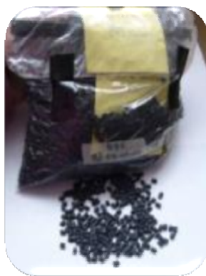
Figura No. 2- 74. Poliamida 6 con 30% de fibra de vidrio Ref. Mazmid B150 FV30
