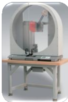
Figura No. 2- 67. Péndulo de Impacto IZOD Caracterización de materiales bajo cargas de impacto
