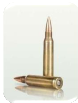
Figura No. 2- 37. Munición de referencia Cal. 5.56 mm para patronamiento de equipos del Laboratorio Balístico.
