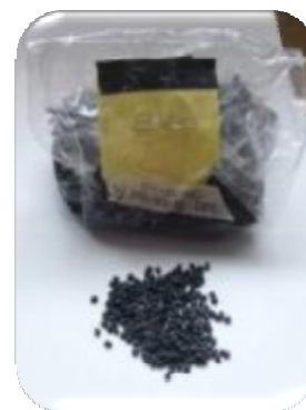
Figura No. 2- 75. Poliamida 66 con modificador de impacto y 33% de fibra de vidrio Ref. Zytel 80G33
