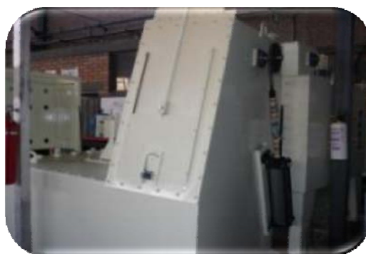
Figura No. 2- 33. Transformación horno salino a horno atmósfera controlada de tipo endotérmico
