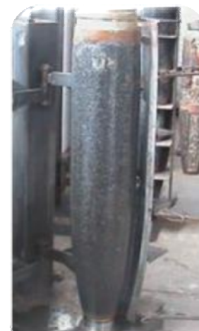
Figura No. 2- 111. Molde para el conformado del Cuerpo en resina y balines
