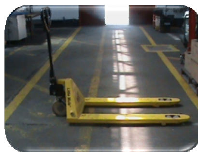
Figura No. 2- 79. Estibadora manual de tipo mecánico de accionamiento hidráulico de capacidad entre 1000 y 2000 kg
