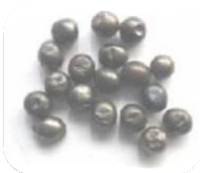
Figura No. 2- 38. Perdigón para munición de escopeta obtenido por sistema de goteo
