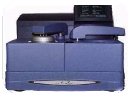
Figura No. 2- 60. DSC Q20 Caracterización de Materiales Rango de temperaturas -40 hasta 400°C Determinación de: punto de fusión, grado de cristalinidad, temperaturas de transición
